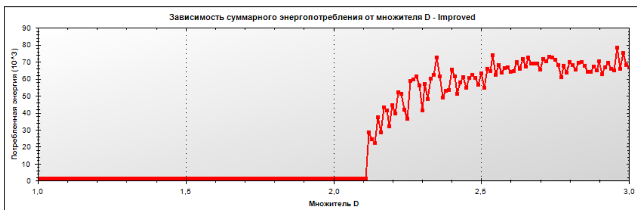
Рис. 19. Зависимость общего энергопотребления от D для алгоритма Improved I для процессора Intel Pentium M
