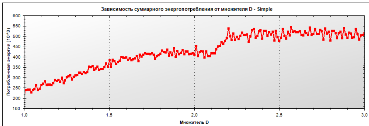
Рис. 18. Зависимость общего энергопотребления от D для базового алгоритма для процессора Intel Pentium M
