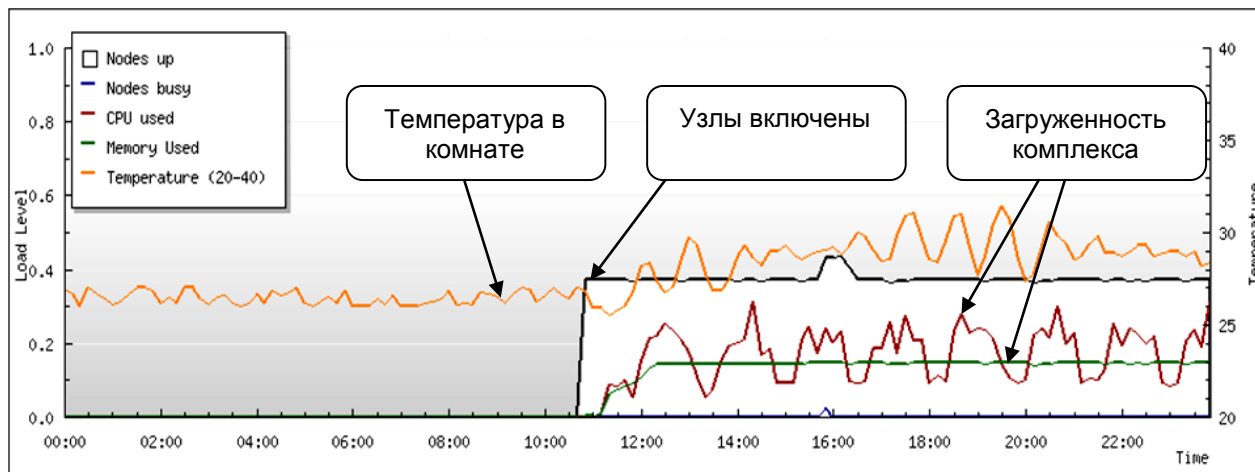
Рис. 2. Мониторинг нагрузки комплекса.
