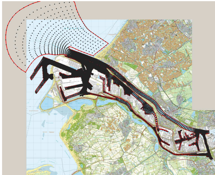
Рис. 3. Вузли розрахункової сітки (всього 25000 вузлів по горизонталі при 20 вертикальних рівнях).
