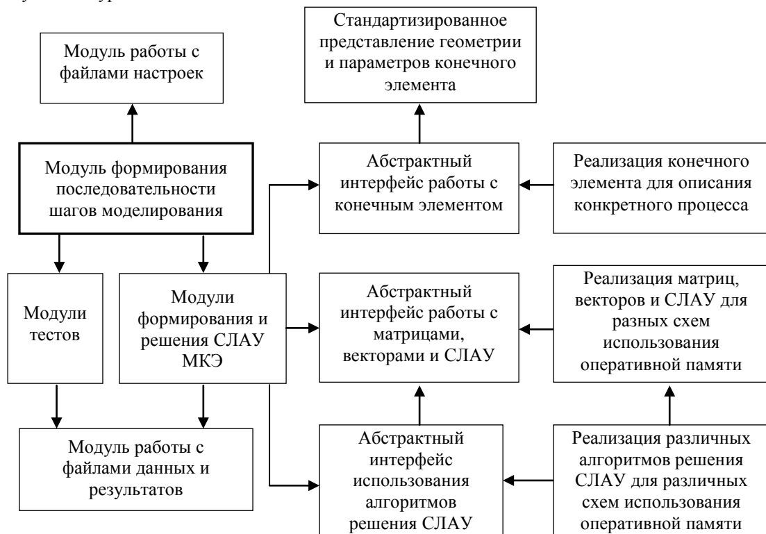
Рис. 1. Схема взаимодействия функциональных модулей конечно-элементного решателя Надра-3D.
